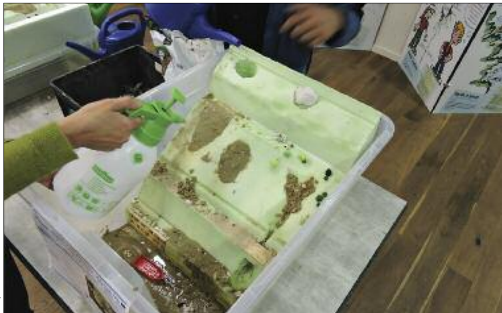
Slika 1: Demonstracijski model za izobraževanje mladih o proženju pobočnih procesov, ki ga je izdelal Jože Papež (Hidrotehnik d. d.).
