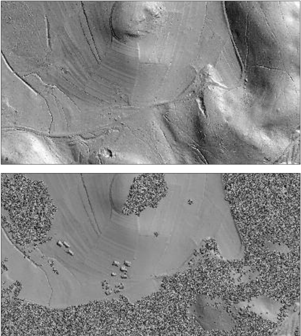
Slika 1: Digitalni modeli višin: (a) digitalni model reliefa (DMR) in (b) digitalni model površja (DMP).
