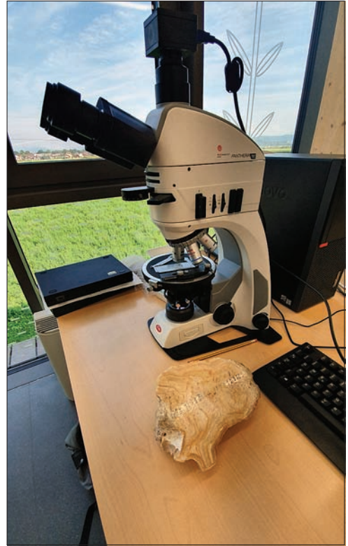
Slika 4: S petrografskim polarizacijskim mikroskopom analiziramo mineralne strukture zbruskov kamnin, sedimentov in sige.
