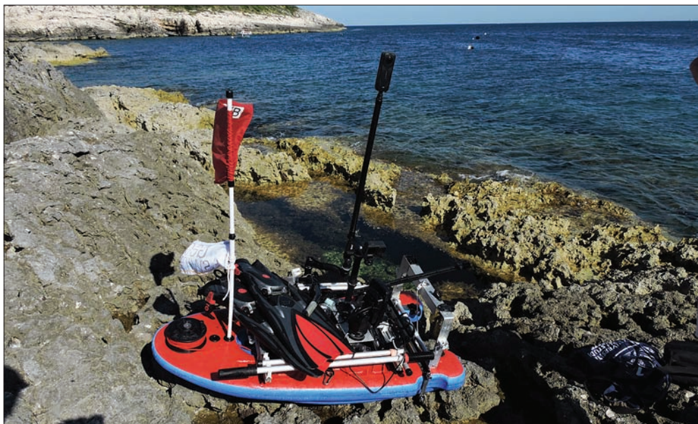
Slika 3: Plavajoča naprava s številnimi kamerami za potrebe 3R kartiranja skalnih obal nad in pod vodo, s katero so tržaški raziskovalci preplavali skoraj celotno zahodno istrsko obalo.
