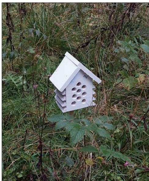
Slika 2: Ohišje z data loggerjem v konti Stanišče na Snežniku.
