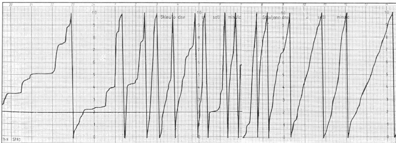
Slika 8. Registracija višine padavin v Kamniški Bistrici od 20. ure 31. oktobra do 15. ure 1. novembra 1990. Ena praznjenje, kar predstavlja vertikalna črta registracije, pomeni 13 mm padavin.
