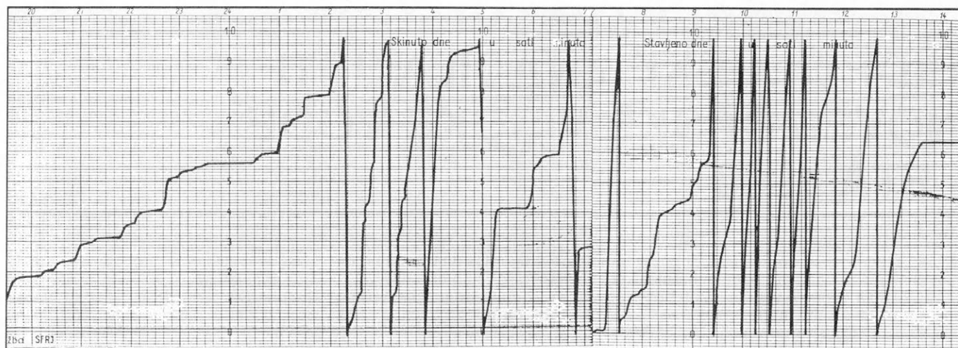
Slika 7. Registracija višine padavin v Javorjih nad Poljanami od 20. ure do 15. ure 1. novembra 1990. Ena praznjenje, kar predstavlja vertikalna črta registracije, pomeni 10 mm padavin.
