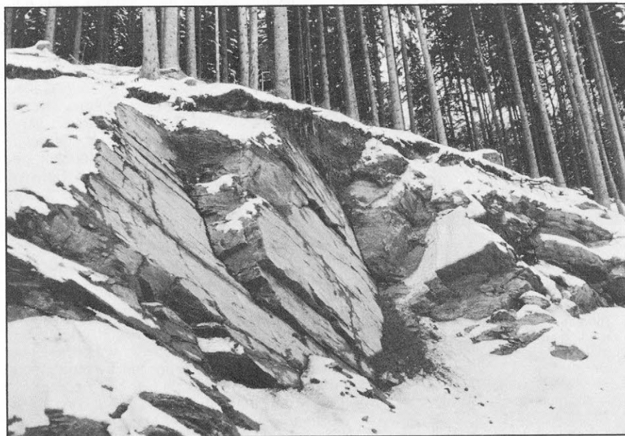
Slika 2. Gnajsi, v katerih je zgrajena pregrada, so v seizmogeološkem pogledu dobra podlaga. (Foto: R. Vidrih)
