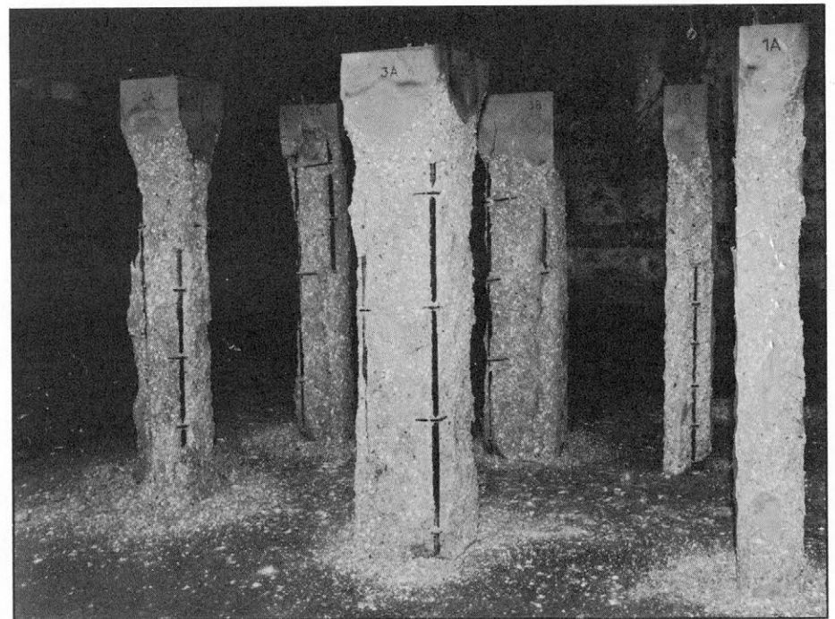
Slika 2. Rezultat testa požarne odpornosti AB-stebrov.
