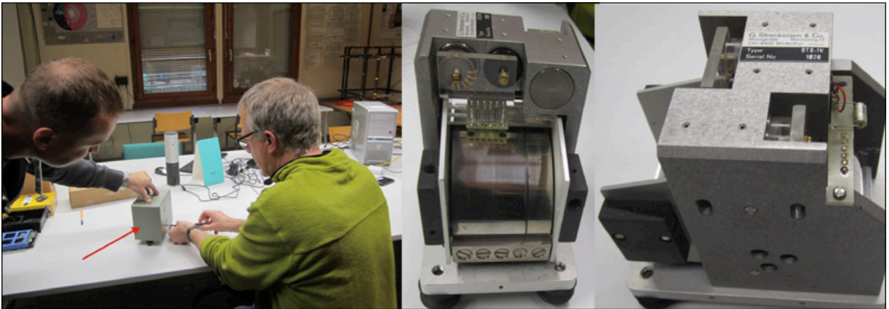
Slika 6: Predstavitev notranjosti vertikalne komponente seizmometra STS-1 (foto: I. Tasič) Figure 6: Interior of the vertical component of the STS-1 seismometer (Photo: I. Tasič)
