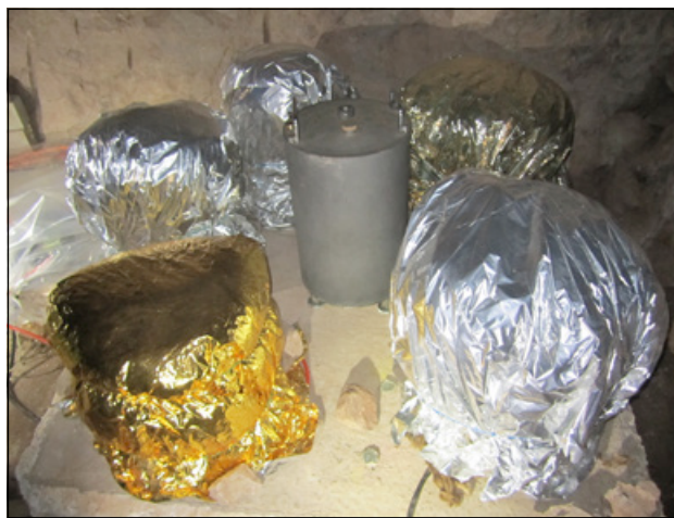
Slika 3: Seizmometri na testnem poligonu na betonskem podstavku v srednjem delu rova so zaščiteni z dodatno termično izolacijsko prevleko. (foto: I. Tasič)
