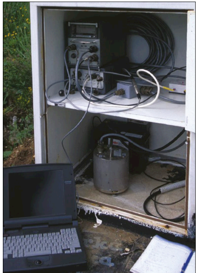
Slika 6: Namestitev seizmografa RefTek 72A-07/DAT (zgoraj) v omarico na potresni opazovalnici Cesta (CESS). Spodaj je bil nameščen seizmometer. (foto: P. Sinčič)
