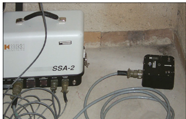
Slika 4: Akceleroigraf SSA-2 z akceleroigrom FBA-23 na začasni opazovalnici v Horjulu (foto: P. Sinčič)
