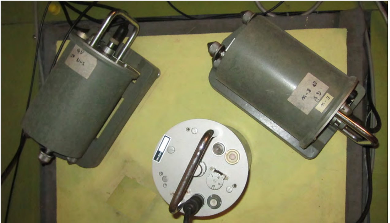
Slika 1: Lega treh enoosnih seizmometrov »Hilger and Watts« modela SG 450 (Wilmore MKII) na Observatoriju na Golovcu. Seizmometer desno zgoraj je postavljen v smeri vzhod-zahod (oznaka E-W), levo zgoraj je postavljen v smeri sever-jug (oznaka N-S), seizmometer spodaj v sredini slike pa meri nihanje tal v navpični smeri. (foto: I. Tasič)
