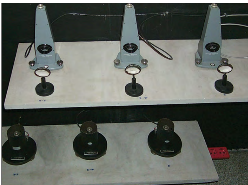
Slika 6: Galvanometri dolgoperiodnega sistema so bili nameščeni na polici nad galvanometri kratkoperiodnega sistema. (avtor: P. Sinčič)
