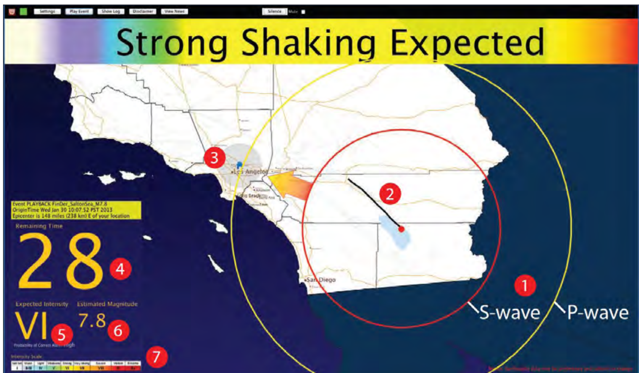
Slika 7: Testni primer izdanega alarma ShakeAlert na zaslonu prenosnega telefona za sistem zgodnjega opozarjanja ob potresu v Kaliforniji. 1 – trenutno čelo P- in S-valov, ki se premika v stvarnem času, 2 – nadžarišče potresa in razvoj prelomnega pretrga, 3 – tvoja lokacija, 4 – sekunde do prihoda potresnega valovanja, 5 – pričakovana intenziteta na tvoji lokaciji, 6 – ocenjena magnituda potresa, 7 – intenziteta lestvica (vir: Burkett in sod., 2014)
