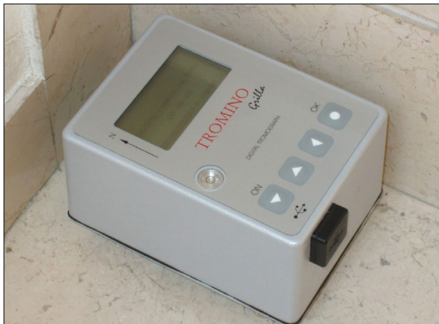
Slika 5: Za meritve mikrotremorjev se uporabljajo posebni seizmografi. S to metodo opredeljujemo osnovne lastne frekvence nihanja sedimentov in objektov ter posledično nevarnost resonančnih učinkov ob potresu (foto: A. Gosar).
