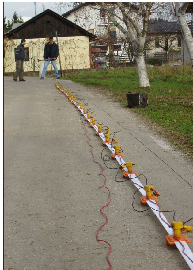
Slika 3: Za določitev hitrosti seizmičnega strižnega valovanja, ki omogoča kvantitativno klasifikacijo sedimentov, se uporablja geofizikalna metoda refrakcijske seizmike. Slika prikazuje tipično refrakcijsko razvrstitev geofonov in generiranje seizmičnega valovanja s težkim kladivom (foto: A. Gosar).
