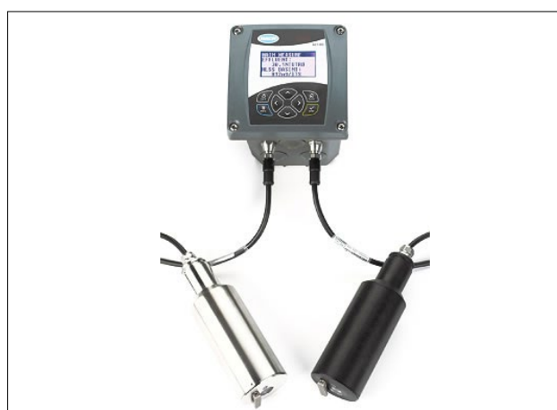
Slika 2: Merilnik motnosti Solitax-sc in komunikacijski vmesnik. (foto: Arhiv ARSO) Figure 2: Turbidity meter Solitax_sc with controller. (Source: ARSO Archives)
