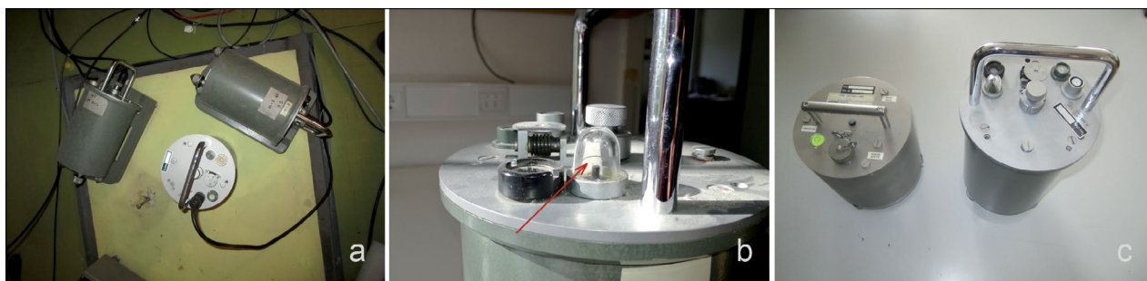
Slika 3: a) Navpični in dva vodoravna seizmometra Willmore Mk-II, nameščena na betonskem steburu; b) indikator ničelne lege seizmometra; c) primerjava kratkoperiodnega enokomponentnega seizmometra Willmore MK-II (desno) s sodobnim širokopasovnim trikomponentnim seizmometrom CMG-40T (levo). (foto: I.Tasič)
