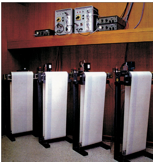
Slika 1: Pogled na analogne pisalnike na observatoriju na Golovcu v Ljubljani, ki beležijo potrese že 45 let. (arhiv ARSO)
