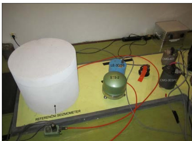
Slika 2: Referenčni seizmometer na observatoriju na Golovcu v Ljubljani je STS-2. Je v beli izolacijski posodi (označena s puščico). Desno od te posode so postavljeni seizmometri, ki so v fazi testiranja: STS-2, LE-3D/5s, CMG-40T in CMG-3ESPC.
