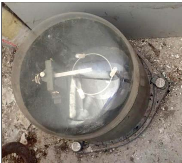
Slika 1: Seizmoskop WM-1 v kleti občinske zgradbe v Brežicah Figure 1: WM-1 seismoscope in the basement of municipal building in Brežice.
