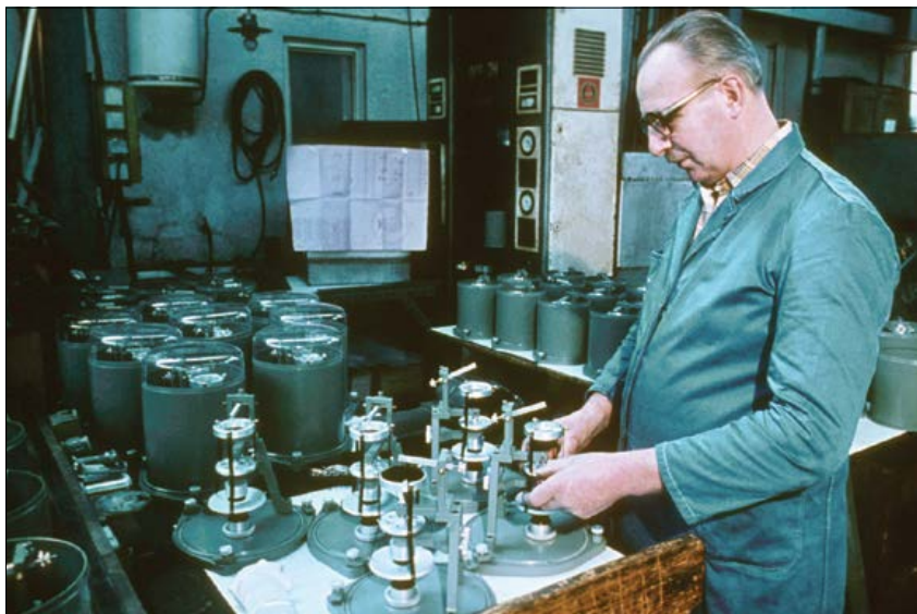
Slika 3: Proizvodna linija za izdelavo seizmoskopov WM-1 v Sloveniji (arhiv ARSO) Figure 3: WM-1 seismoscope production line in Slovenia (ARSO archive).
