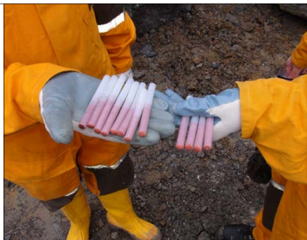
Slika 6: a) prepakiranje eksploziva iz originalne embalaže b) PVC-patrone, premera 10 mm, ki omogočajo optimalno polnjenje vrtin majhnih premerov do 12 mm (foto: M. Merela)
