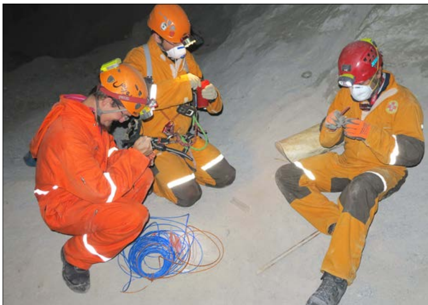
Slika 10: Priprava minskih patron iz prosojnih plastičnih cevčic, napolnjenih z industrijskim razstrelivom Ergodyn 30 E (foto: M. Merela)
