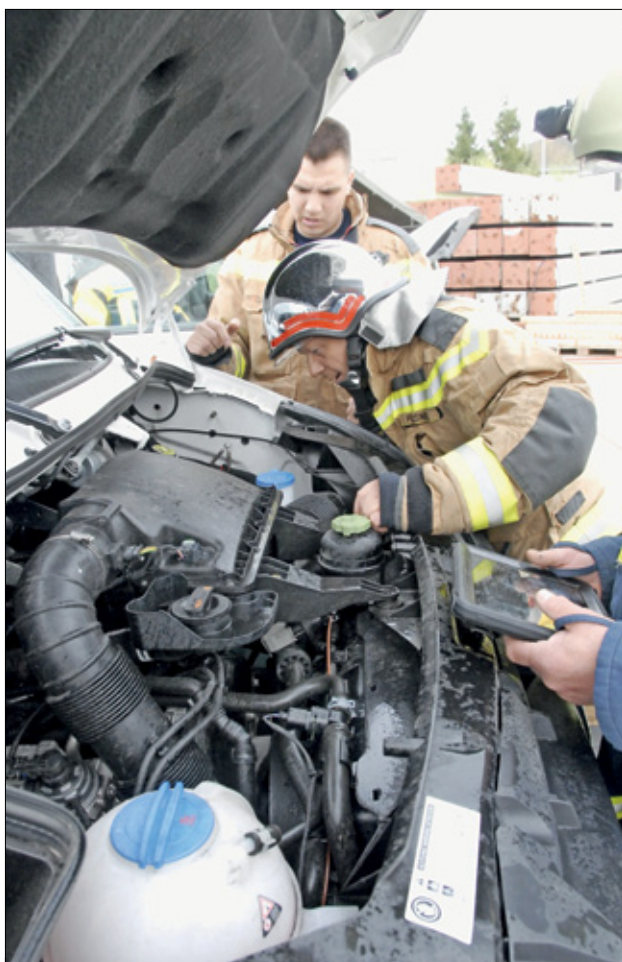
Slika 10: Delovno mesto št. 2; udeleženci so izvedeli, kje imajo sodobna kombinirana in poltovorna vozila nameščen akumulator. (foto: B. Kuntarič)
