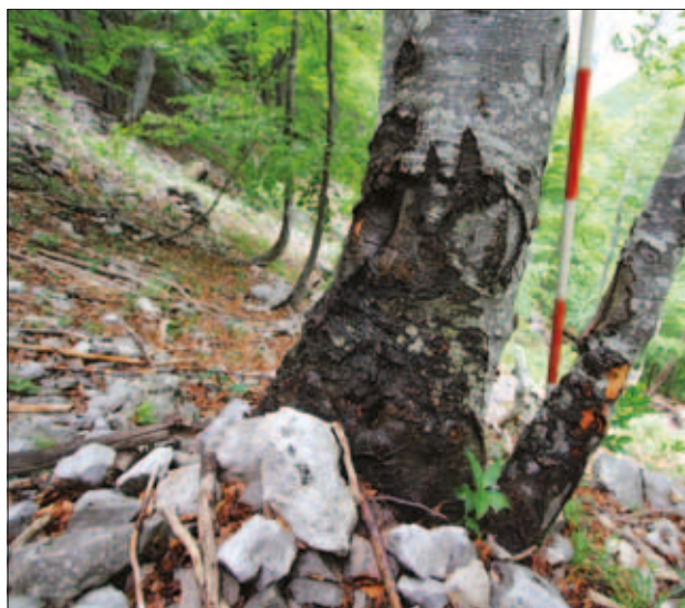
Slika 3: Neme pričje – število, velikost in svežina poškodb zaradi udarcev padajočega kamenja na drevesnih debljih so lahko v pomoč pri presoji nevarnosti. (foto: J. Papež) Figure 3: Silent witnesses – number, size and freshness of injuries caused by rockfalls on tree trunks may be helpful in assessing the risk (photo: J. Papež).
