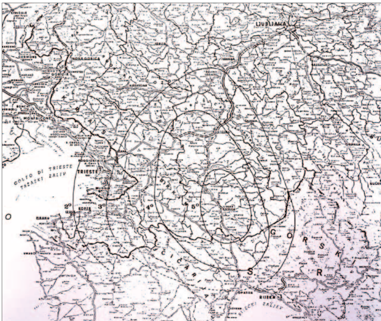
Slika 1: Učinki potresa oziroma intenzitete 10. oktobra 1982 na ilirskobistriškem območju (Vidrih, 1983) Figure 1: Earthquake effects (intensity) on 10 October 1982 in the Ilirskobistriška area (Vidrih, 1983).
