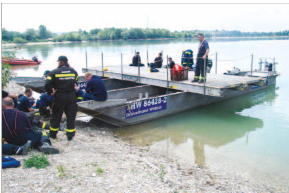
Slika 18: Plavajoči pontonski sistem Figure 18: Modular pontoon system.
