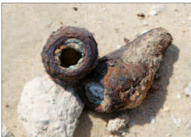
Slika 21: Različne klimatske razmere zelo različno delujejo na mine in NUS. Skoraj nerazpoznavni vžigalniki za strelivo velikega kalibra, Irak 2009 (foto: S. Saunders)
