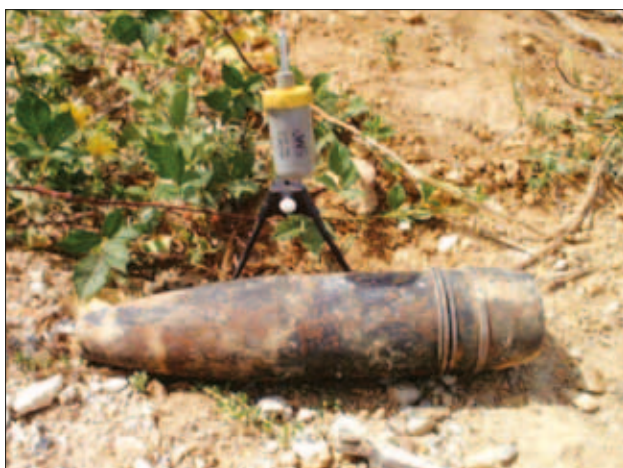
Slika 17: Uničenje NUS 100 mm s švicarskim EOD-sistemom SM 33, Kosovo 2000 (foto: arhiv MACC)
