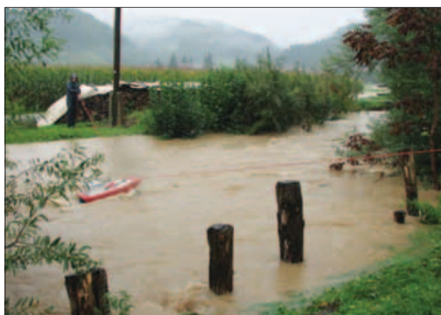
Slika 9: Uspešno izvedena meritev z ADMP s frekvenco 600 kHz na vodomerni postaji Dvor – Gradaščica (foto: M. Burger)
