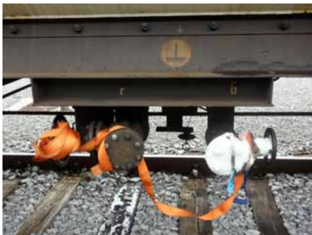
Slika 1: Veliki in mali ventil. Iz malega je izhajal propilen. (foto: J. Perko)
