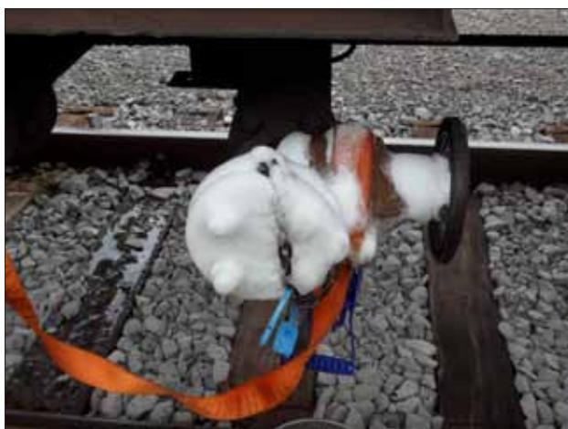
Slika 3: Jeseniški poklicni gasilci so poskušali zatesniti poškodovani ventil, vendar jim to ni povsem uspelo. (foto: J. Perko)
