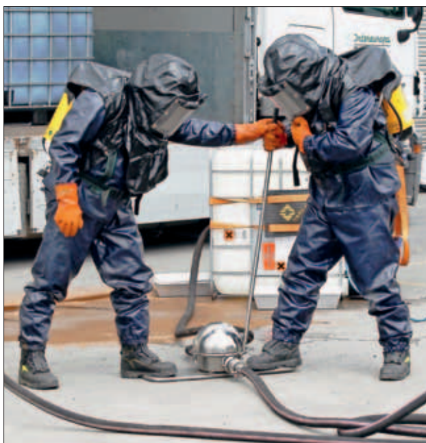
Slika 13: Prečrpavanje nevarne snovi v varno posodo (foto: B. Toič)
