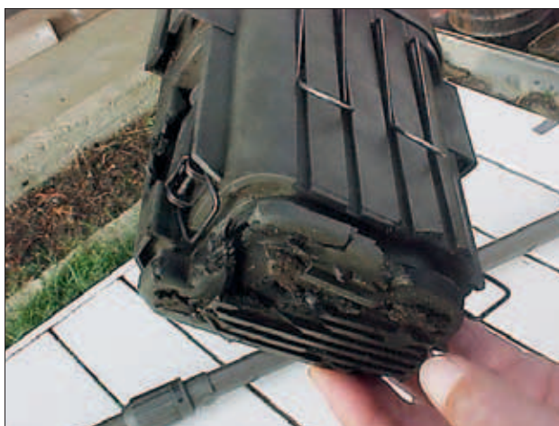
Slika 15: V delovni minski nesreči na Šar planini poškodovan minski detektor, Kosovo 2000 (foto: Arhiv MACC)
