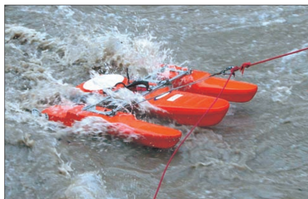
Slika 24: ADMP-meritev pretoka na reki Selška Sora, 23. 12. 2009 (foto: R. Trček) Figure 24: ADCP discharge measurement on the Selška Sora River on 23 December 2009 (photo: R. Trček)
