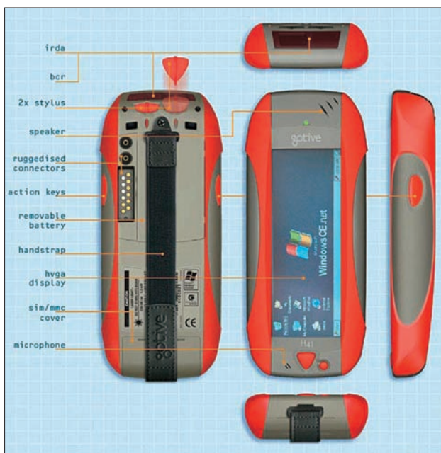
Slika 3: Primer mobilnega klienta, preizkušenega v okviru projekta. Črna elastika na spodnji strani (leva slika) omogoča uporabniku, da si napravo natakne na roko in jo z drugo roko upravlja.
