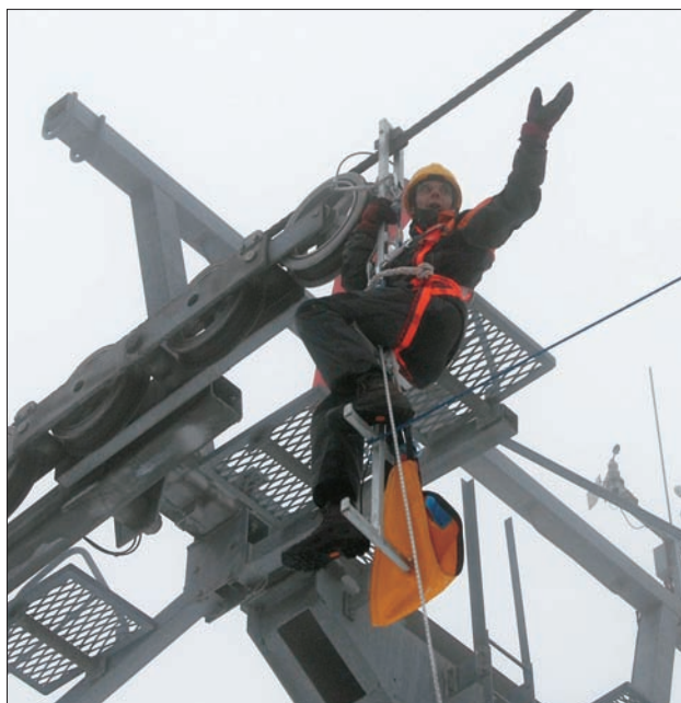
Slika 6: Naprava girak je obešena na jeklenico sedežnice in pripravljena na pot do kabine. (foto: B. Kuntarič)
