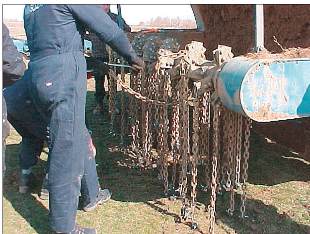
Slika 7: Izvajanje akreditacije mlatilke Armtrack 325, skladno z ISHMC, Kosovo, Uroševac – okolica 2000. (foto: M. Bizjak)
