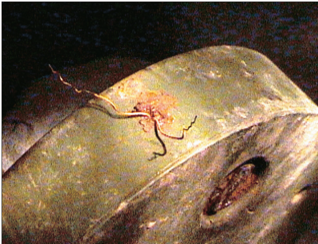
Slika 17: IMAS ne opredeljujejo delovanja proti IED, čeprav postaja »moderno« – protitankovska mina, prirejena na komandni vžig, Kosovo 1999. (foto: Arhiv MACC)
