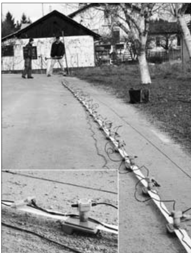
Slika 4. Povezana razvrstitev geofonov ( land streamer ) s 24 geofoni in kovaško kladivo kot seizmični vir; majhna vstavljena slika prikazuje pritrditve geofona na premične sani
