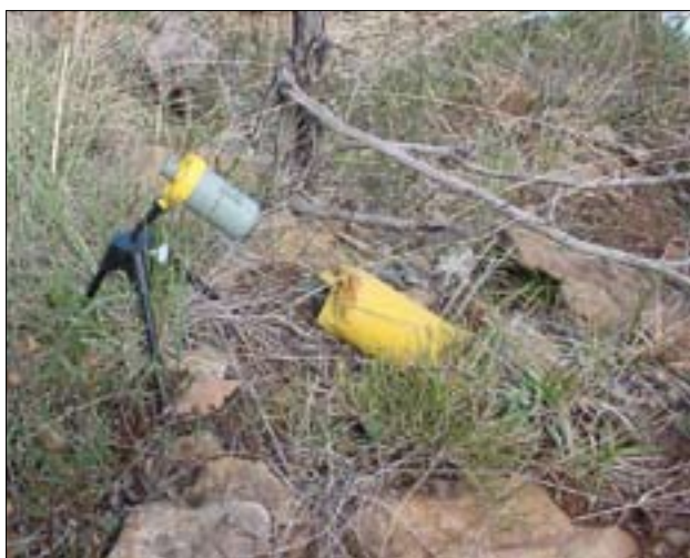
Slika 16. Uničevanje kasetnic (deflagracija) s švicarskim sistemom RUAG SM-EOD, ki so ga na Kosovu preizkusili prvič, Kosovo 2000 (foto: arhiv MACC)
