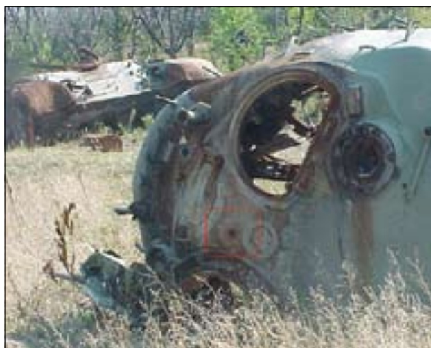
Slika 6. Tank VJ, ki so ga uničile kasetnice, z rdečo barvo označeno mesto zadetka, Kosovo, Grebnik 1999 (foto: M. Bizjak)
