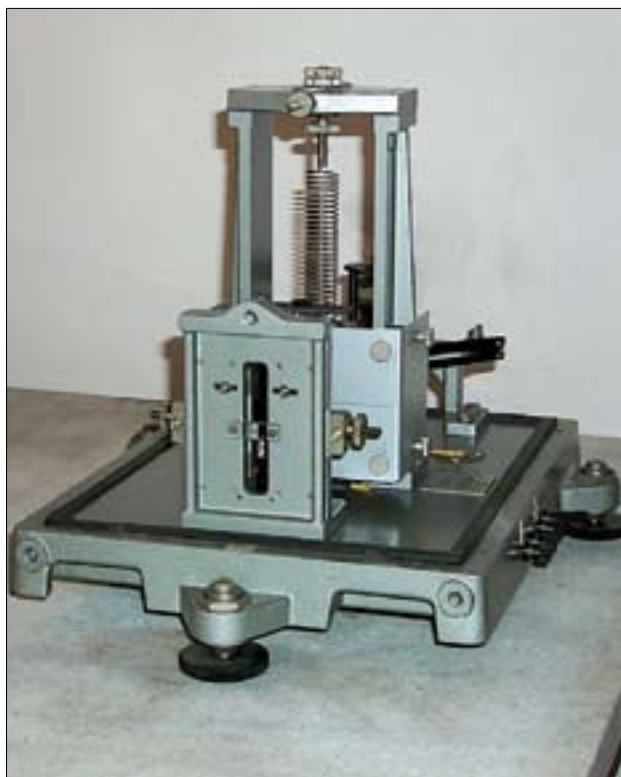
Slika 2. V prvi polovici leta 1958 so seizmologi kupili navpični kratkoperiodni seizmograf Stuttgart. Elektromagnetni seizmograf je izdelal znani nemški seizmolog Wilhelm Hiller. Imel je galvanometrski optični registrator z zapisom na fotografski papir. Redno je začel zapisovati potrese marca 1959 in je neprekinjeno deloval do sredine leta 1979
