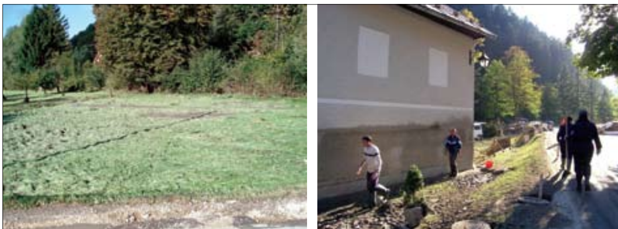
Slika 1. Ugotavljanje poplavnih sledov po rastlinju: poležana trava (foto: M. Bat) in po sledih na stavbah (foto: B. Komac).
