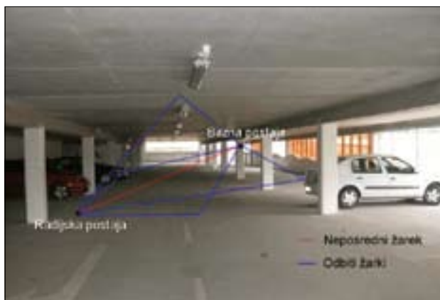
Slika 1. Žarkovni model razširjanja radijskega signala v garaži
