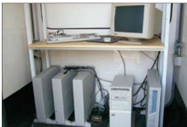
Slika 3. Samodejna potresna opazovalnica. Analogno-digitalni pretvornik je spremenil analogni signal seizmometra v digitalni zapis, ki je bil po dodatni samodejni računalniški obdelavi po klicni telefonski zvezi prenešen v centralni računalnik v SOP.
