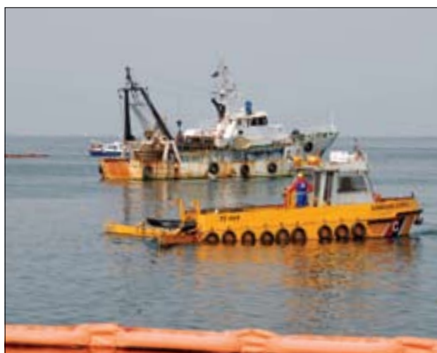
Slika 1. Okoli poškodovane ladje so že postavljene luške baraže. Okoli ladje pluje čoln, ki z morske površine pobira izteklo pogonsko gorivo.
