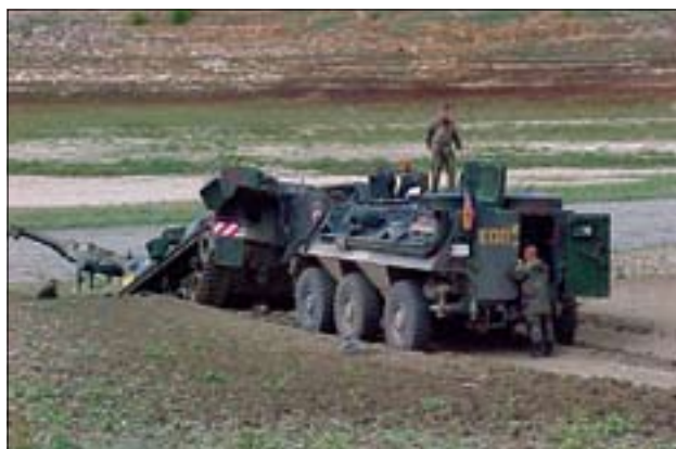
Slika 15. Nemški pripadniki KFOR z mlatilko Keiller izvajajo razminiranje področja v okolici Vrbničkega jezusa, Kosovo 2000 (foto: M. Bizjak). Figure 15. Demining by German KFOR members with the Keiller flail near Vrbnički Dam, Kosovo 2000 (photo: M. Bizjak).
