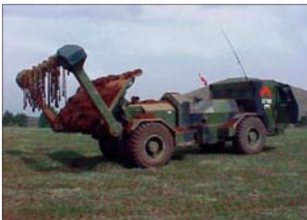
Slika 6. Finska vojaška mlatilka Adrima na Kosovu certificirana za humanitarno razminiranje, Kosovo 2000 (foto: arhiv MACC).
