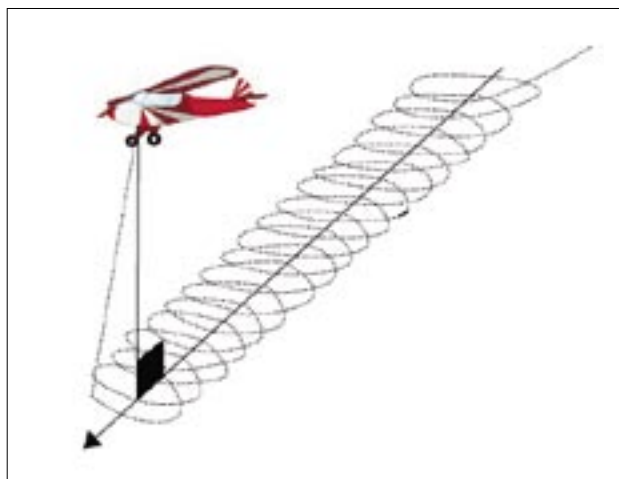
Slika 1. Potek letalskega laserskega skeniranja (LiDAR) Figure 1. Principle of airborne laser scanning (LiDAR)
