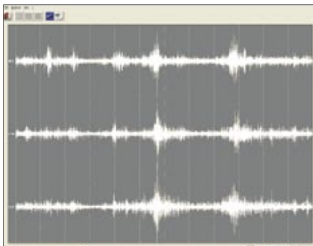
Slika 6. Seizmični zapis mikrotremorjev na dveh vodoravnih (S-J in V-Z) in vertikalni (U-D) komponenti.
