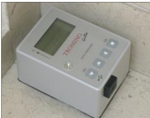
Slika 5. Seizmograf za meritve mikrotremorjev Tromino.
