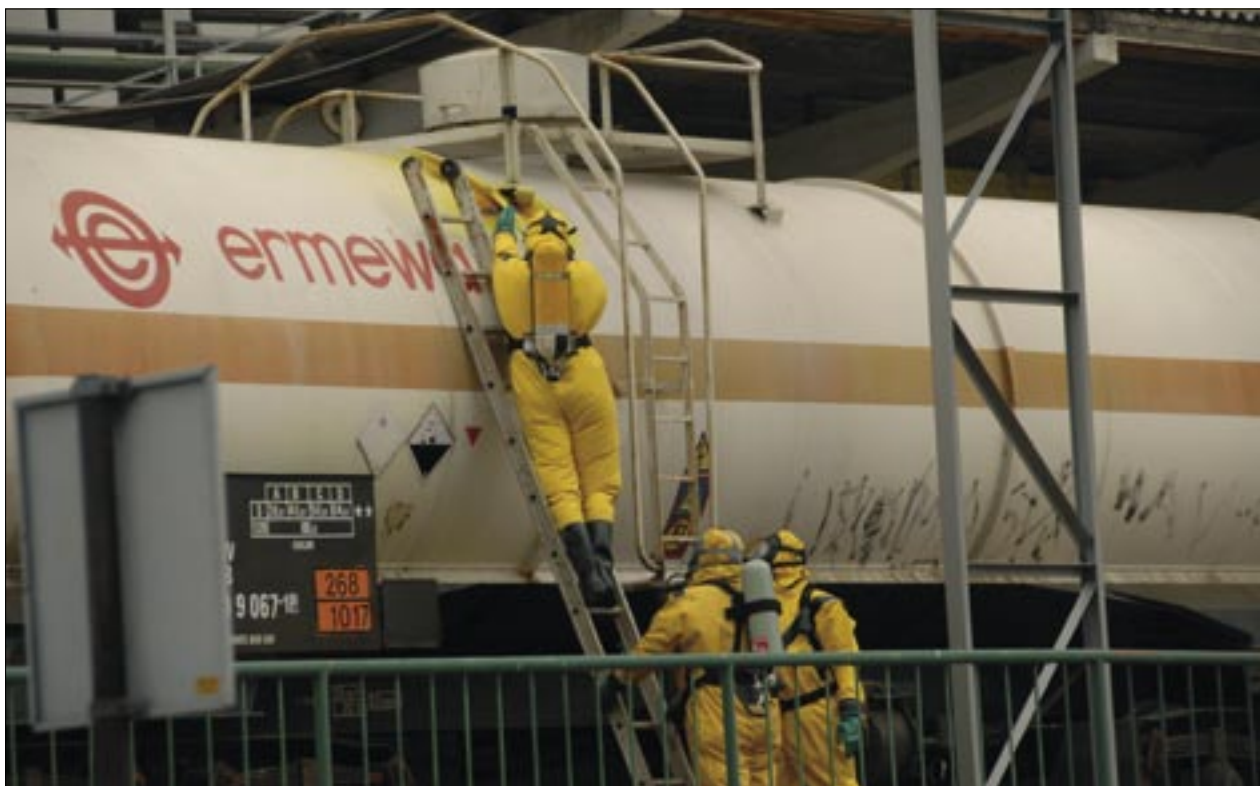
Slika 3. Trije pripadniki Industrijske reševalne enote Klor so namestili čep v luknjo, skozi katero je izhajal klor in nevaren plin je ostal tam, kjer mora biti, v varni cisterni.
