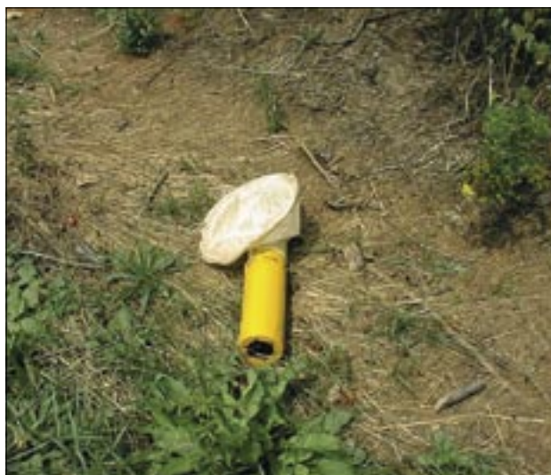
Slika 19. Izvidovanje NUS in kasetnic je lažje, ker so njihovi ostanki opazni na površini, še nevarna BLU 97, Istok, 1999 (foto: M. Bizjak)
