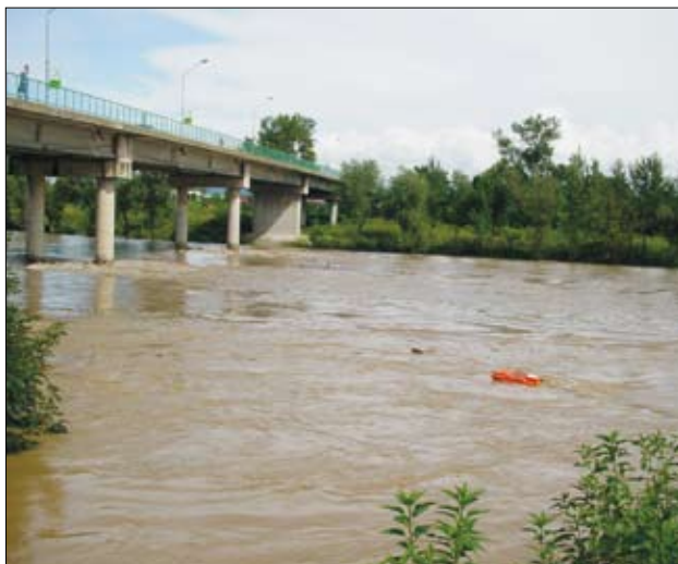
Slika 4. Izvajanje meritve hitrosti in pretoka vode z akustičnim Dopplerjevim merilnikom ADCP v Čatežu na Savi 22. 8. 2005 (foto: M. Burger)
