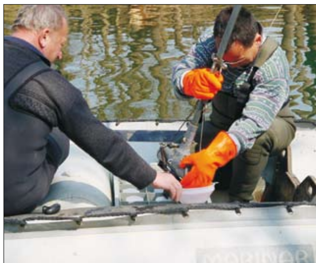
Slika 2. Odvzem vzorcev z batometrom (foto: F. Ulaga)
