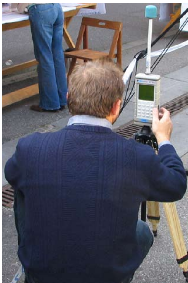
Slika 7. Merilnik PMM 853 z merilno sondo EP-183 za merjenje EMS ob dnevih zaščite, reševanja in pomoči 2005 v Mariboru
