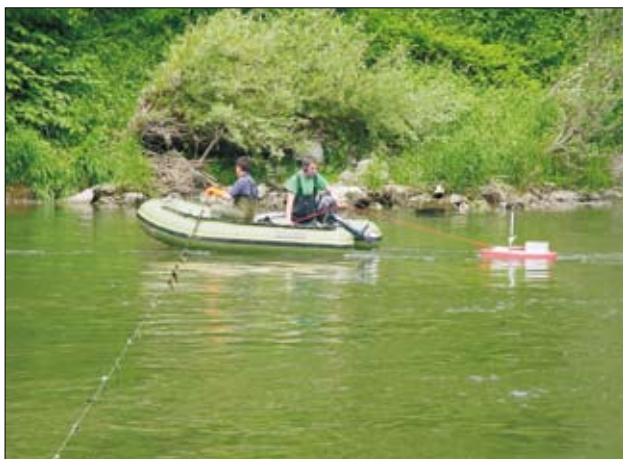
Slika 4. Prehod struge z gumijastim čolnom. Ob visokih vodah se uporablja motorni pogon (foto: M. Burger)
