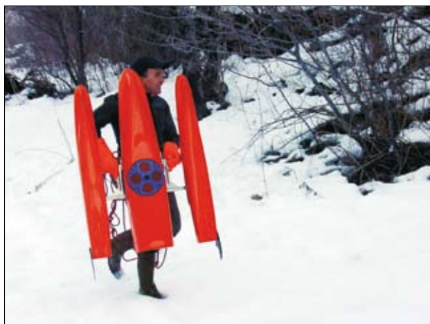
Slika 1. Primer ultrazvočnega merilnika vrste WorkHorse Rio Grande 1200 kHz podjetja Teledyne RD Instrument, pritrjenega na čolniček, t. i. trimaran. Merilnik deluje na podlagi primerjanja dveh parov podatkov, za vzpostavitev kontrole izmerjenih vrednosti (foto: R. Trček)
