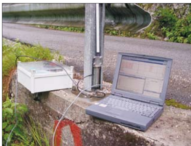
Slika 2. Merilna (strojna) oprema za izvedbo meritve: radijski modem ter terenski prenosnik za sprotno kontrolo podatkov (foto: R. Trček)
