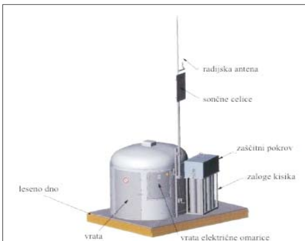
Slika 2. Kontrolno mesto v obliki kupole (shematski prikaz)
