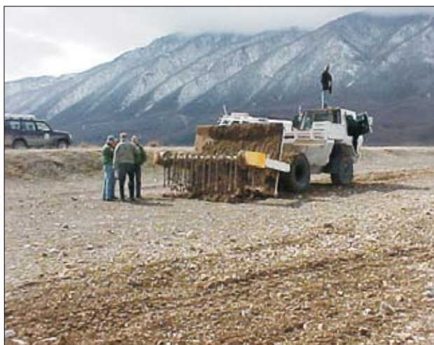
Slika 4. Finska mlatilka Patria RA-140 DS med preskušanjem za pridobitev akreditacije za delo na Kosovu, Belo polje, 1999 (foto: M. Bizjak)
