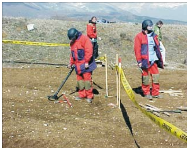
Slika 12. Strojno razminiranje ne dosega standardov humanitarnega razminiranja (99,6%), zato mora biti delo vedno pregledano ročno ali s psi, Glogovac, Kosovo, 1999 (foto: M. Bizjak)
