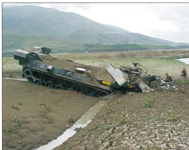
Slika 6. Težki stroji imajo kar precej omejitev gibljivosti, mlatilka Keiller v blatu Vrbničkega jeza, Kosovo 2000 (foto: M. Bizjak)
