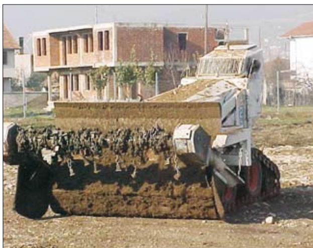
Slika 8. Norveško mlatilko Minecat 230 je na Kosovu uporabil NPA, kjer pa je pokazala veliko pomanjkljivosti, Peč, Kosovo, december 1999 (foto: M. Bizjak)
