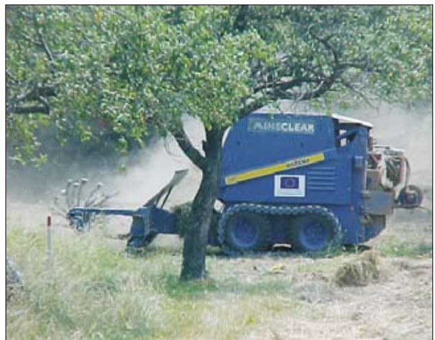
Slika 1. Slovaški stroj Božena je dokaj uporaben za razminiranje gosto naseljenih predelov, Kosovo, vas Streoce (foto: M. Bizjak)
