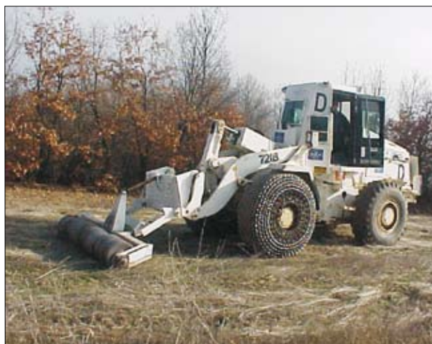
Slika 9. Valjar Halo Trusta je pogojno uporaben zgolj proti PPM, Vučitrn, Kosovo, 2000 (foto: M. Bizjak)
