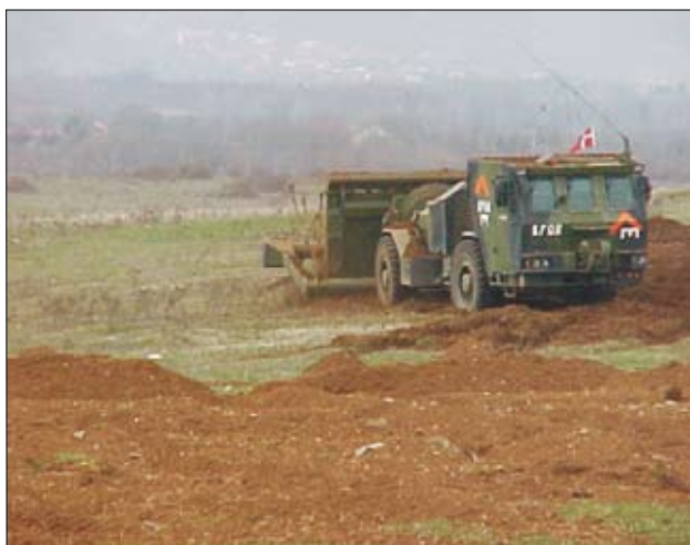
Slika 3. Danska mlatika Hydrema MVC 910, pred strojem je viden t. i. redem – kopičenje zemlje, Kosovo, 1999 (foto: arhiv MACC)
