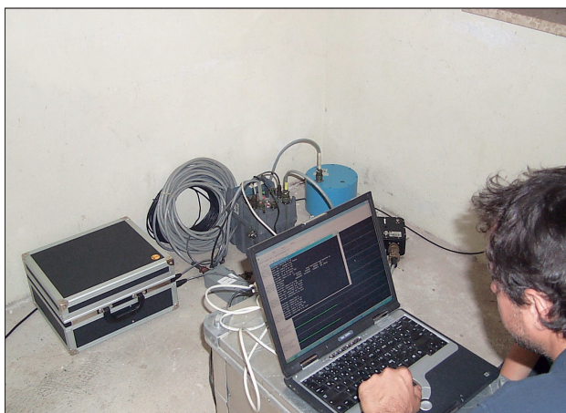
Slika 1. Strokovnjaki Urada za seizmologijo in geologijo Agencije RS za okolje so v prvih urah po potresu namestili tri začasne potresne opazovalnice, ki so v prvih dneh zaznale več sto popotresnih sunkov. Slika kaže postavitev seizmografa v Srpenici. (foto: M. Gostinčar)
